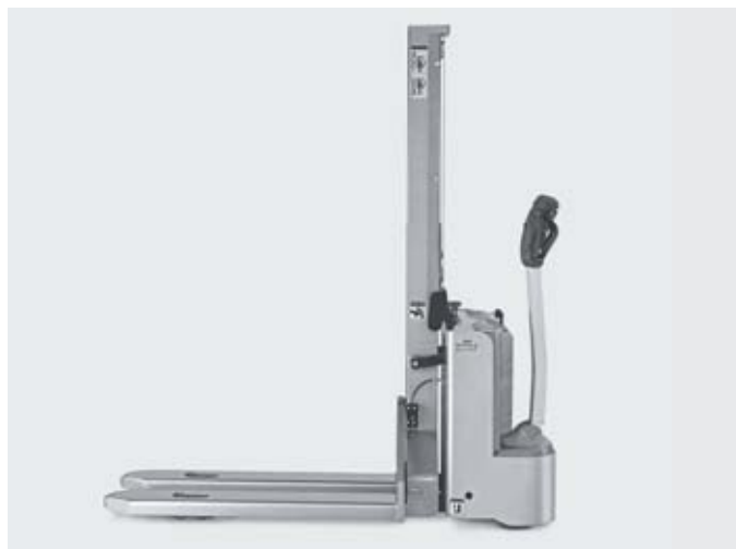
Stabilità eccellente grazie al telaio con quattro punti di appoggio
