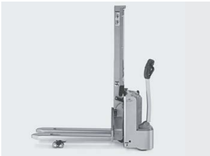
Migliore manovrabilità anche sulle pavimentazioni irregolari grazie al sollevamento iniziale (opzionale)
